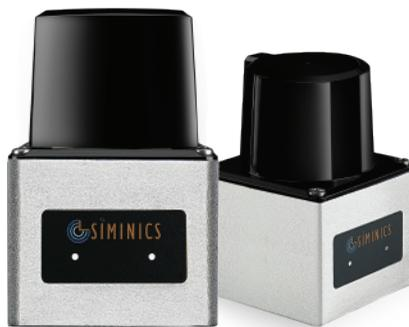
PAVO提供业内顶尖的 $0.08^\circ$  最小角分辨率，实现对周围环境的精细还原。用户可以通过配置改变电机转速，从而使输出的点云图像帧率在10-30 Hz范围内调节。PAVO提供精细角分辨率的同时也提供了高采样率，从而使其对微小目标的识别能力大大增强，有效降低漏检率。
