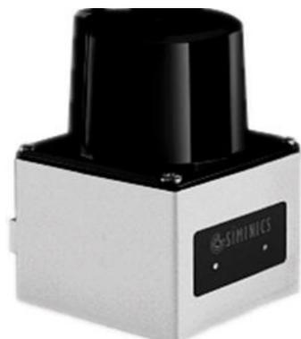
**PAVO** 是由星秒科技 ( SIMINICS ) 研发的高性能激光雷达产品。采用飞行时间 ( TOF , Time Of Flight ) 原理设计 , 通过对激光脉冲反射过程的精密时间测量 , 获得高精度的距离信息 , 配合电机旋转完成对周围环境的二维扫描。
